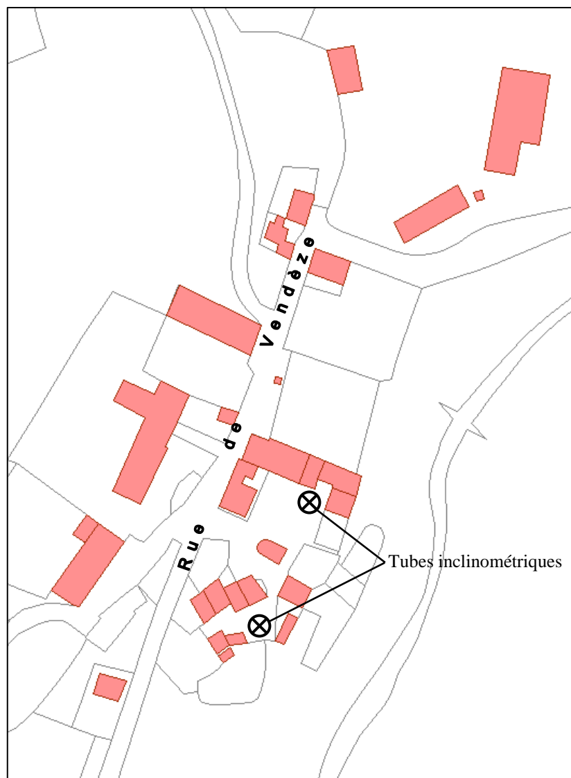
Emplacement approximatif des tubes inclinométriques au hameau de Vendèze
