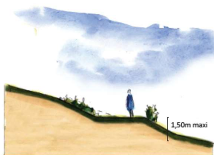
Principe de réalisation des talus végétalisés.
