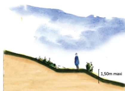
Principe de réalisation des talus végétalisés.
