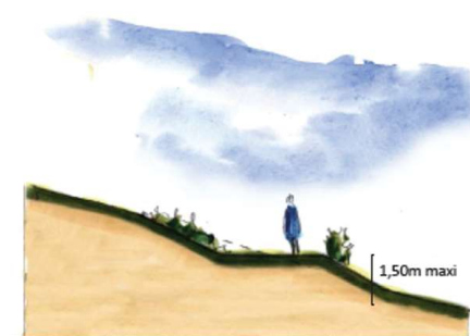
Principe de réalisation des talus végétalisés.
