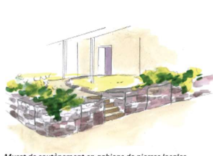
Muret de soutènement en gabions de pierres locales.
