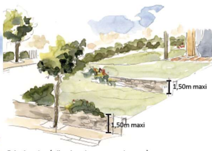
Principe de réalisation des murets de soutènement.
