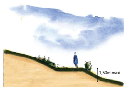
Principe de réalisation des talus végétalisés.
