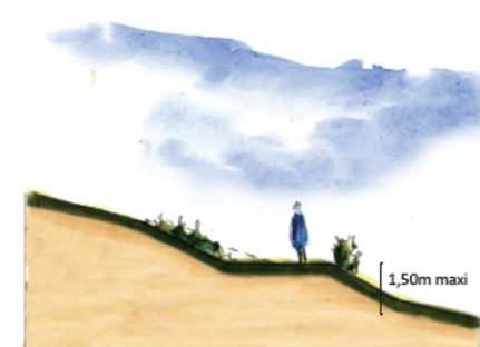
Principe de réalisation des talus végétalisés.
