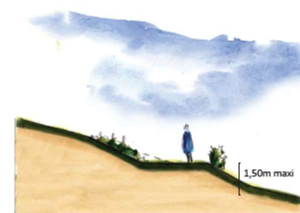
Principe de réalisation des talus végétalisés.
