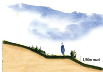
Principe de réalisation des talus végétalisés.
