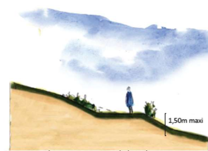
Principe de réalisation des talus végétalisés.
