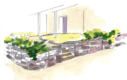
Muret de soutènement en gabions de pierres locales.
