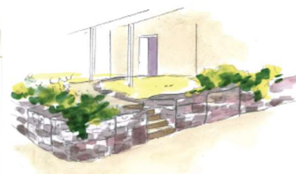
Muret de soutènement en gabions de pierres locales.
