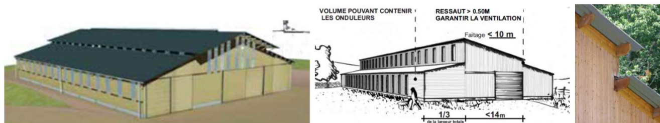
Exemple de toiture symétrique et asymétrique et de ressauts dans la couverture- source : CAUE15
