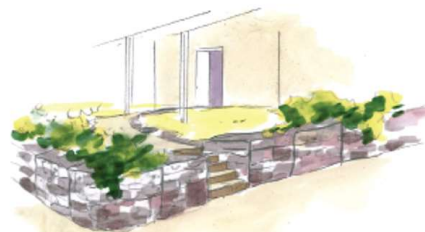
Muret de soutènement en gabions de pierres locales.
