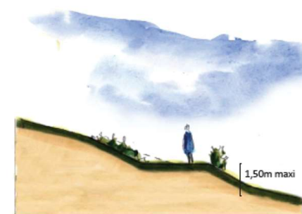
Principe de réalisation des talus végétalisés.
