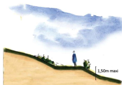
Principe de réalisation des talus végétalisés.
