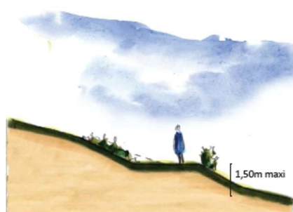
Principe de réalisation des talus végétalisés.
