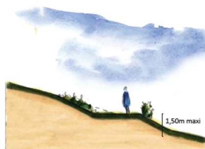
Principe de réalisation des talus végétalisés.
