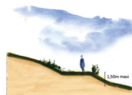
Principe de réalisation des talus végétalisés.
