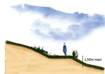
Principe de réalisation des talus végétalisés.
