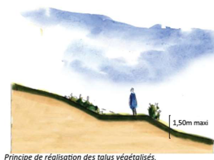
Principe de réalisation des talus végétalisés.
