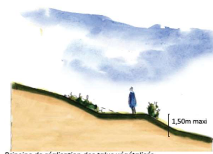
Principe de réalisation des talus végétalisés.
