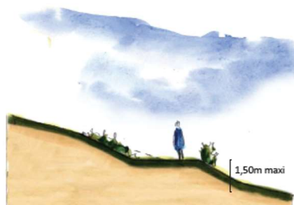
Principe de réalisation des talus végétalisés.
