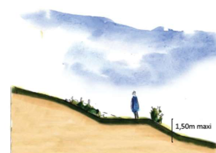
Principe de réalisation des talus végétalisés.
