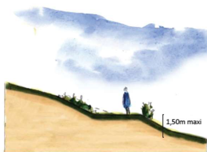
Principe de réalisation des talus végétalisés.
