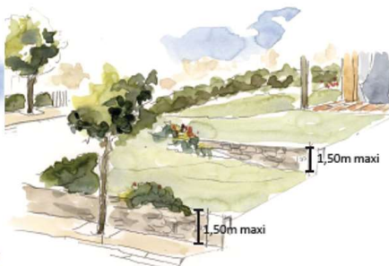
Principe de réalisation des murets de soutènement.
