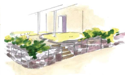
Muret de soutènement en gabions de pierres locales.
