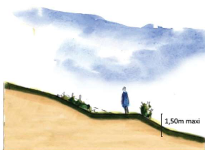
Principe de réalisation des talus végétalisés.
