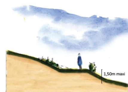
Principe de réalisation des talus végétalisés.
