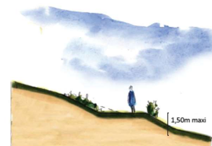
Principe de réalisation des talus végétalisés.
