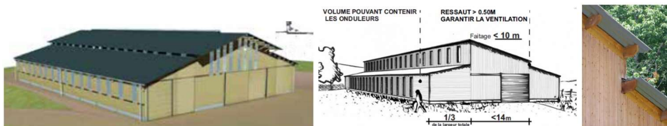
Exemple de toiture symétrique et asymétrique et de ressauts dans la couverture- source : CAUE15
