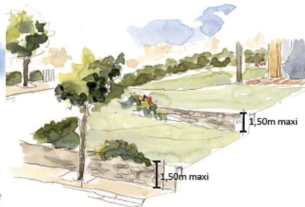
Principe de réalisation des murets de soutènement.
