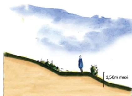
Principe de réalisation des talus végétalisés.
