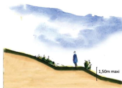
Principe de réalisation des talus végétalisés.
