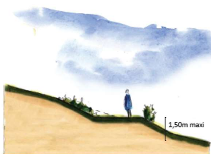
Principe de réalisation des talus végétalisés.
