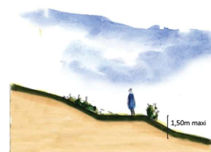
Principe de réalisation des talus végétalisés.
