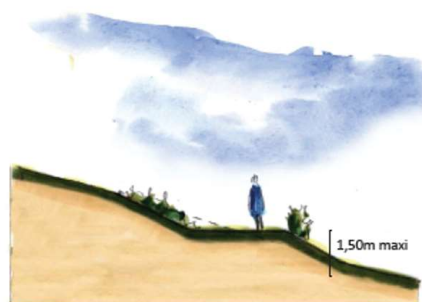
Principe de réalisation des talus végétalisés.
