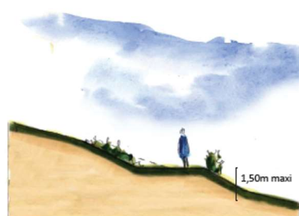
Principe de réalisation des talus végétalisés.
