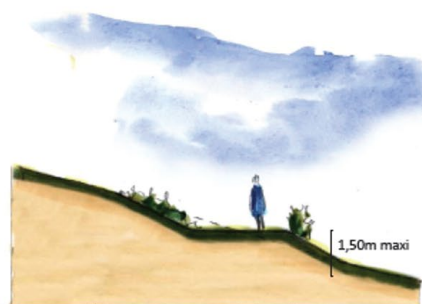
Principe de réalisation des talus végétalisés.
