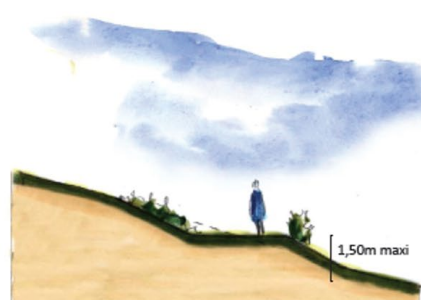
Principe de réalisation des talus végétalisés.
