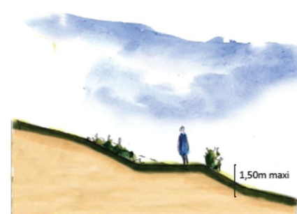
Principe de réalisation des talus végétalisés.
