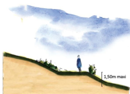
Principe de réalisation des talus végétalisés.
