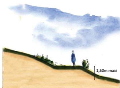
Principe de réalisation des talus végétalisés.
