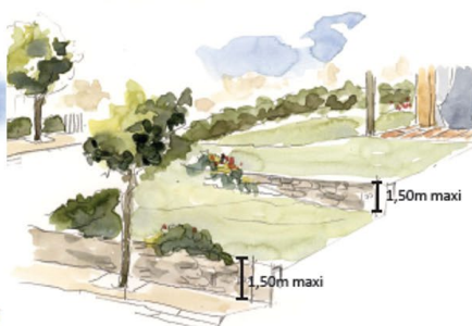
Principe de réalisation des murets de soutènement.
