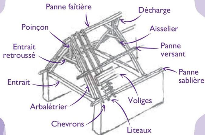
De manière générale, dans le bâti ancien, la charpente demande à être analysée avec soin et traitée (principalement contre un insecte : le capricorne).
