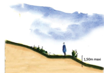
Principe de réalisation des talus végétalisés.
