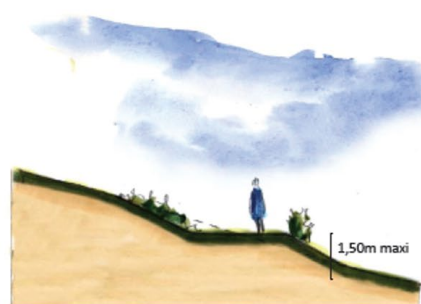
Principe de réalisation des talus végétalisés.
