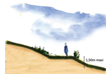
Principe de réalisation des talus végétalisés.
