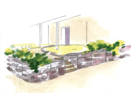
Muret de soutènement en gabions de pierres locales.
