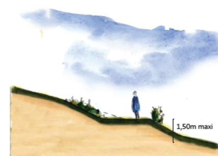
Principe de réalisation des talus végétalisés.
