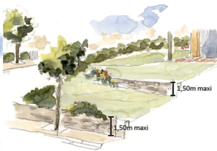
Principe de réalisation des murets de soutènement.
