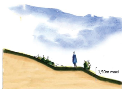
Principe de réalisation des talus végétalisés.
