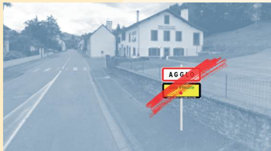
Panneau d'entrée d'agglomération (EB10) non réglementaire car associé à un panneau de label sur le même mât.
