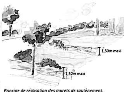
Principe de réalisation des murets de soutènement.
