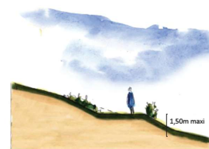
Principe de réalisation des talus végétalisés.
