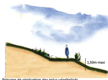
Principe de réalisation des talus végétalisés.
