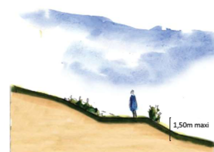
Principe de réalisation des talus végétalisés.
