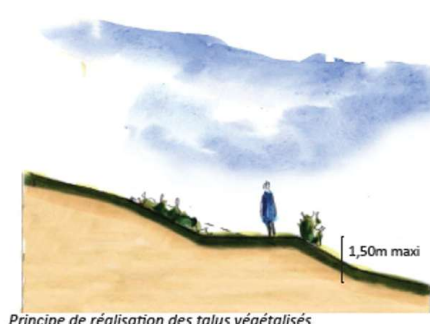
Principe de réalisation des talus végétalisés.
