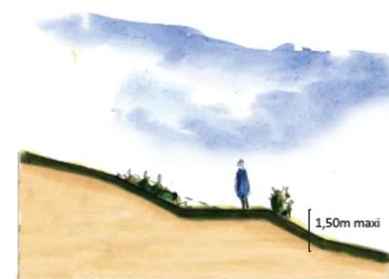
Principe de réalisation des talus végétalisés.
