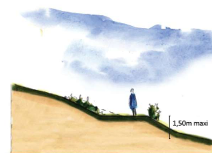
Principe de réalisation des talus végétalisés.
