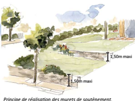
Principe de réalisation des murets de soutènement.
