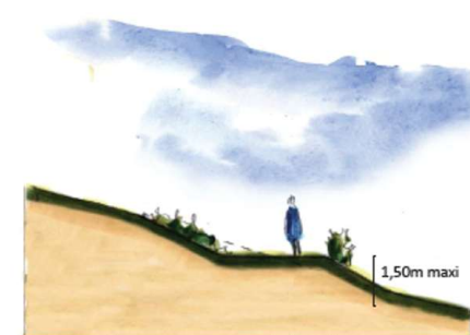
Principe de réalisation des talus végétalisés.
