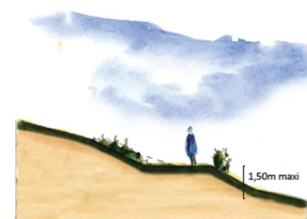
Principe de réalisation des talus végétalisés.
