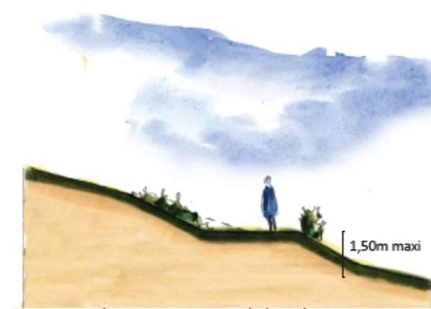
Principe de réalisation des talus végétalisés.
