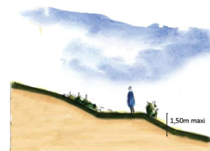
Principe de réalisation des talus végétalisés.
