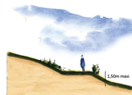
Principe de réalisation des talus végétalisés.
