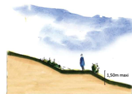
Principe de réalisation des talus végétalisés.
