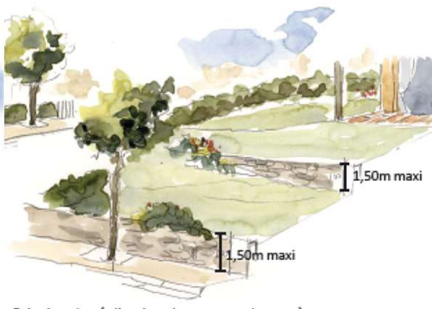
Principe de réalisation des murets de soutènement.
