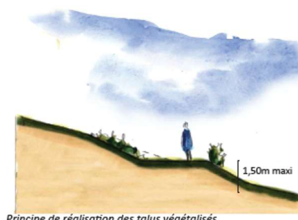
Principe de réalisation des talus végétalisés.
