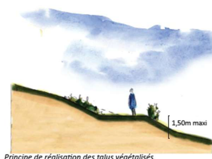
Principe de réalisation des talus végétalisés.
