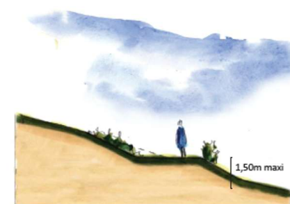
Principe de réalisation des talus végétalisés.
