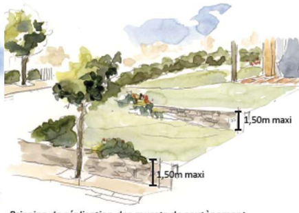
Principe de réalisation des murets de soutènement.
