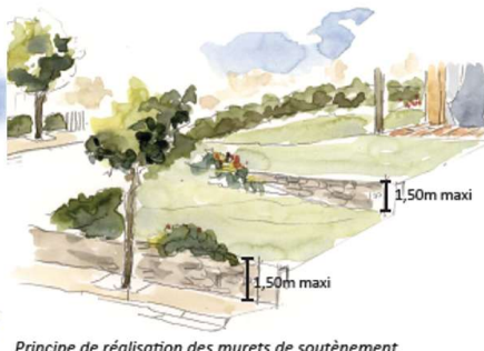
Principe de réalisation des murets de soutènement.
