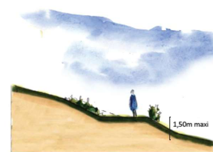
Principe de réalisation des talus végétalisés.
