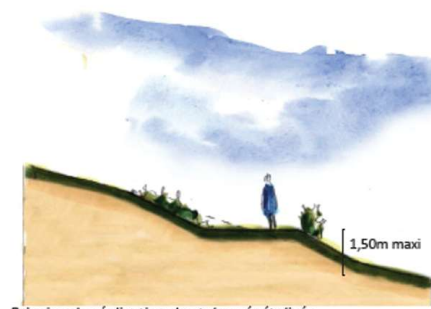
Principe de réalisation des talus végétalisés.
