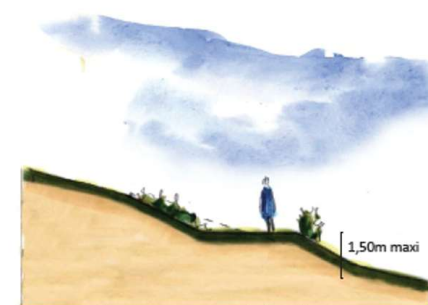
Principe de réalisation des talus végétalisés.
