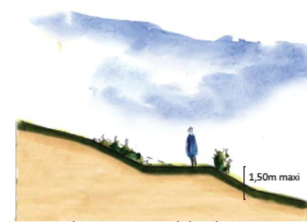
Principe de réalisation des talus végétalisés.
