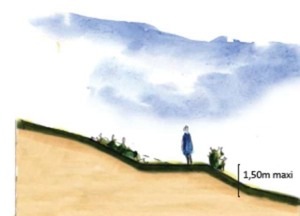
Principe de réalisation des talus végétalisés.
