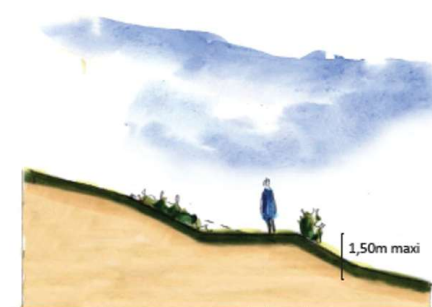
Principe de réalisation des talus végétalisés.
