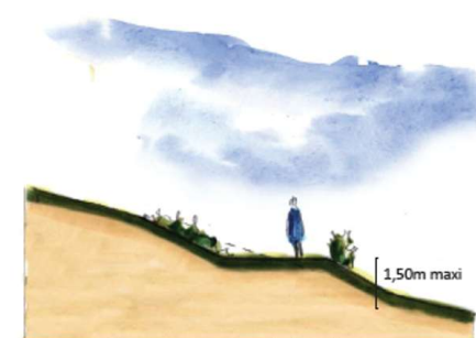
Principe de réalisation des talus végétalisés.
