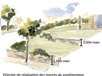
Principe de réalisation des murets de soutènement.
