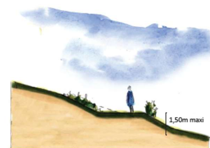
Principe de réalisation des talus végétalisés.
