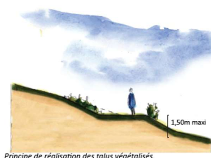
Principe de réalisation des talus végétalisés.
