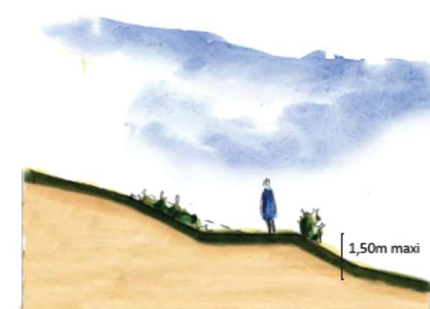
Principe de réalisation des talus végétalisés.
