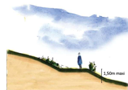
Principe de réalisation des talus végétalisés.
