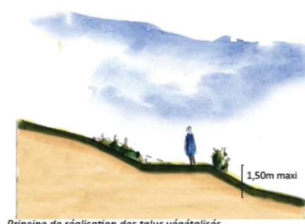
Principe de réalisation des talus végétalisés.
