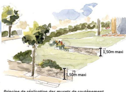
Principe de réalisation des murets de soutènement.
