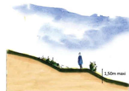
Principe de réalisation des talus végétalisés.
