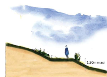
Principe de réalisation des talus végétalisés.
