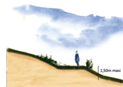
Principe de réalisation des talus végétalisés.
