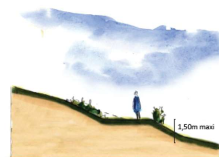
Principe de réalisation des talus végétalisés.
