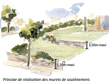
Principe de réalisation des murets de soutènement.
