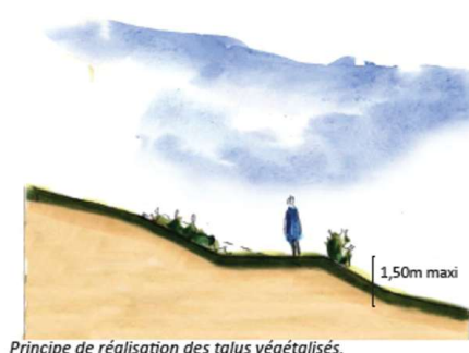
Principe de réalisation des talus végétalisés.
