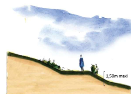
Principe de réalisation des talus végétalisés.
