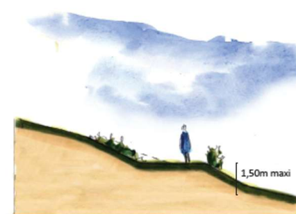
Principe de réalisation des talus végétalisés.
