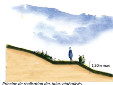
Principe de réalisation des talus végétalisés.
