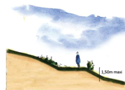
Principe de réalisation des talus végétalisés.
