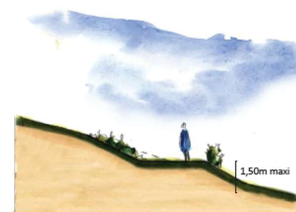
Principe de réalisation des talus végétalisés.
