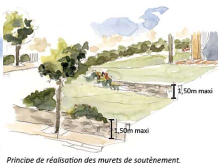
Principe de réalisation des murets de soutènement.
