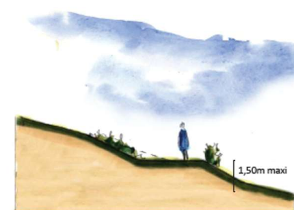
Principe de réalisation des talus végétalisés.
