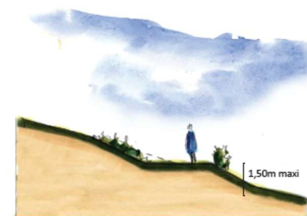
Principe de réalisation des talus végétalisés.
