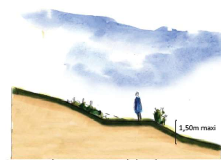
Principe de réalisation des talus végétalisés.
