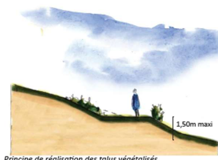
Principe de réalisation des talus végétalisés.
