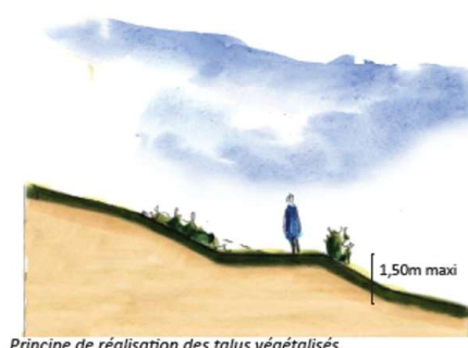
Principe de réalisation des talus végétalisés.
