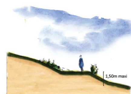
Principe de réalisation des talus végétalisés.
