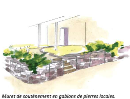
Muret de soutènement en gabions de pierres locales.
