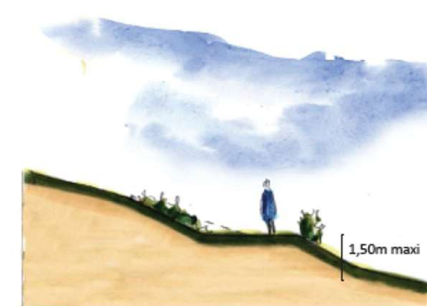
Principe de réalisation des talus végétalisés.
