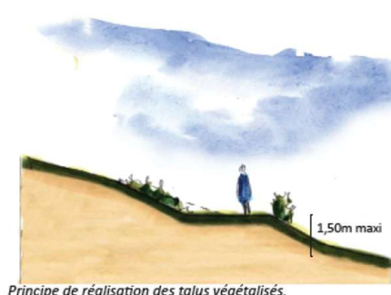
Principe de réalisation des talus végétalisés.
