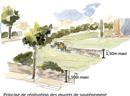
Principe de réalisation des murets de soutènement.
