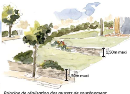
Principe de réalisation des murets de soutènement.
